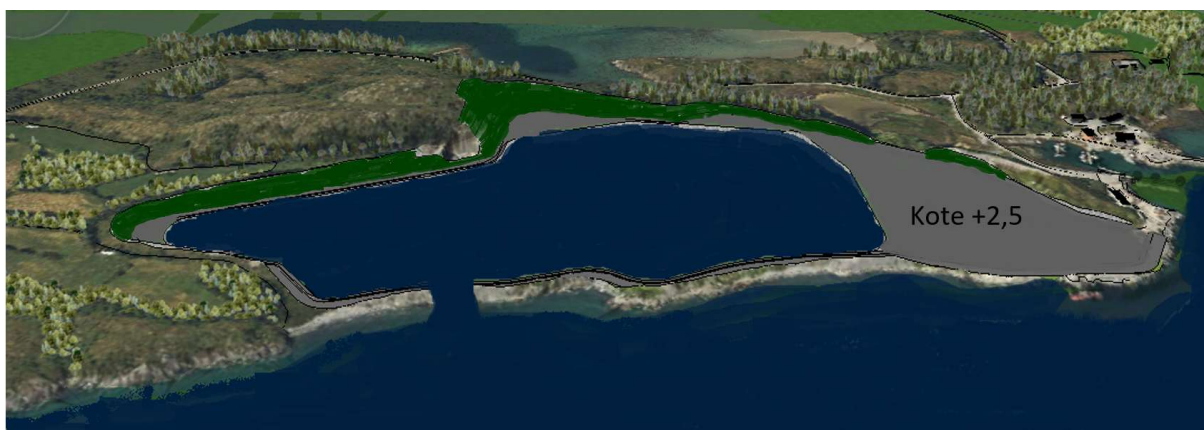
Figur 17. Avsluttet uttak. Det er sprengt ut en åpning til sjøen slik at utsprengt areal fylles med sjøvann.
