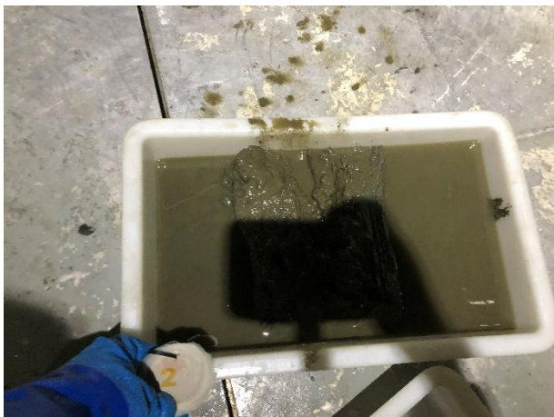
Figur 7: Bilder som viser sedimentet fra stasjon 2 før og etter siling. Sedimentet besto av leire og silt. Foto: Aqua Kompetanse AS.
