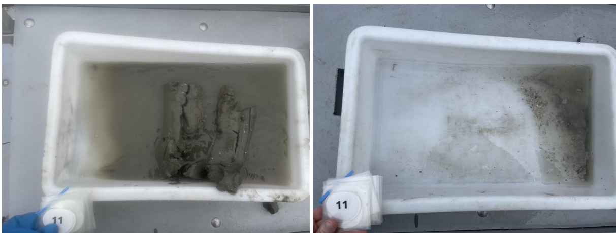
Figur 16: Bilder som viser sedimentet fra stasjon 11 før og etter siling. Sedimentet besto av leire og silt. Foto: Aqua Kompetanse AS.
