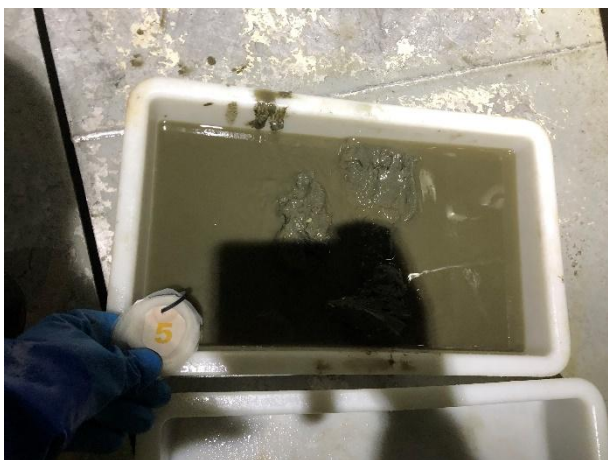
Figur 10: Bilder som viser sedimentet fra stasjon 5 før og etter siling. Sedimentet besto av leire og silt. Foto: Aqua Kompetanse AS.
