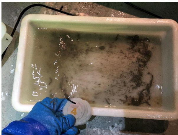
Figur 9: Bilder som viser sedimentet fra stasjon 4 før og etter siling. Sedimentet besto av leire og silt. Foto: Aqua Kompetanse AS.
