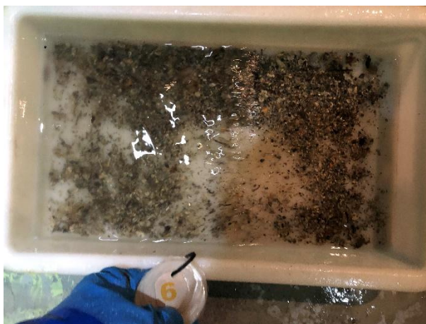
Figur 11: Bilder som viser sedimentet fra stasjon 6 før og etter siling. Sedimentet besto av leire og silt. Foto: Aqua Kompetanse AS.
