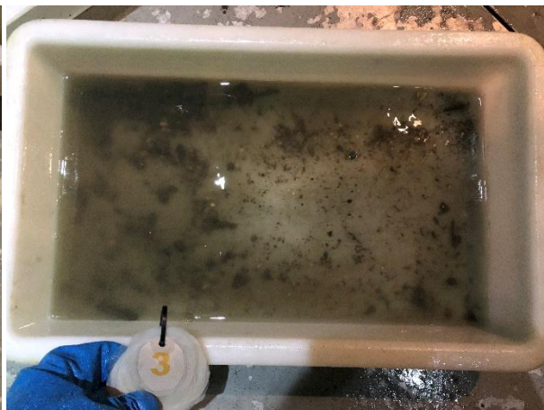
Figur 8: Bilder som viser sedimentet fra stasjon 3 før og etter siling. Sedimentet besto av leire og silt. Foto: Aqua Kompetanse AS.
