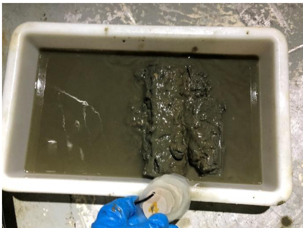
Figur 9: Bilder som viser sedimentet fra stasjon 4 før og etter siling. Sedimentet besto av leire og silt. Foto: Aqua Kompetanse AS.
