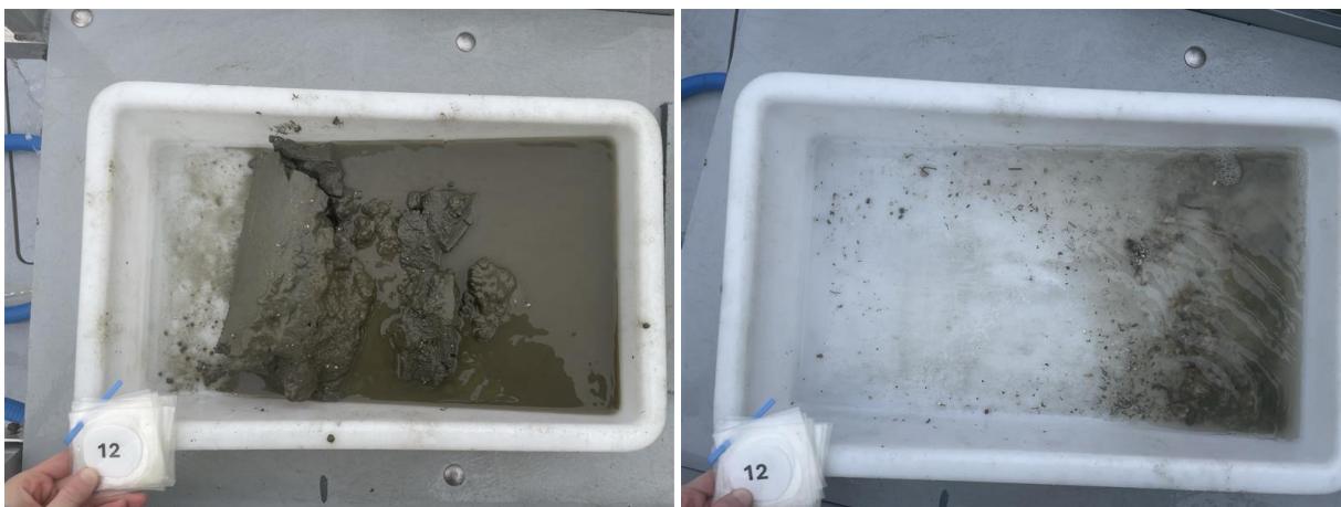
Figur 17: Bilder som viser sedimentet fra stasjon 12 før og etter siling. Sedimentet besto av leire og silt. Foto: Aqua Kompetanse AS.
