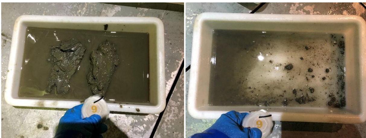
Figur 14: Bilder som viser sedimentet fra stasjon 9 før og etter siling. Sedimentet besto av leire og silt. Foto: Aqua Kompetanse AS.
