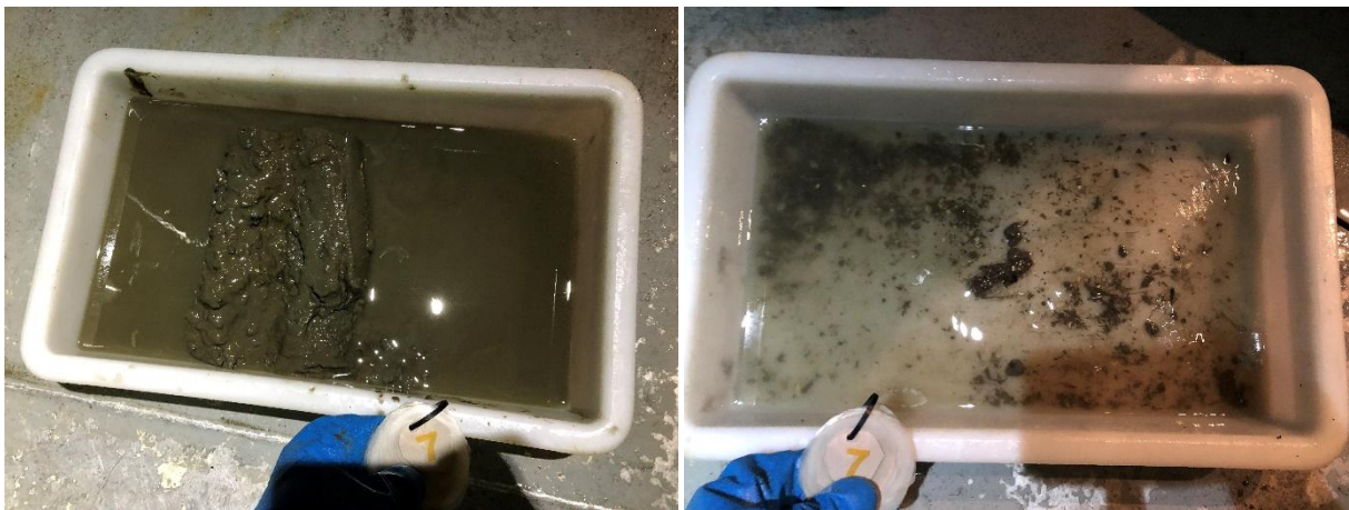
Figur 12: Bilder som viser sedimentet fra stasjon 7 før og etter siling. Sedimentet besto av leire og silt. Foto: Aqua Kompetanse AS.
