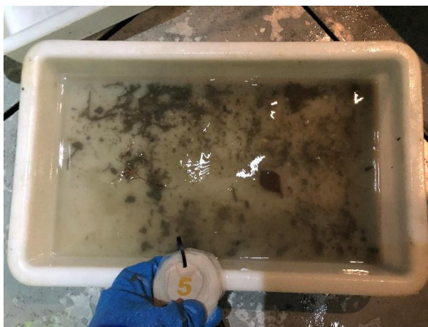
Figur 10: Bilder som viser sedimentet fra stasjon 5 før og etter siling. Sedimentet besto av leire og silt. Foto: Aqua Kompetanse AS.
