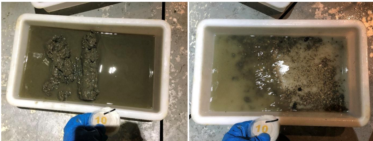
Figur 15: Bilder som viser sedimentet fra stasjon 10 før og etter siling. Sedimentet besto av leire og silt. Foto: Aqua Kompetanse AS.
