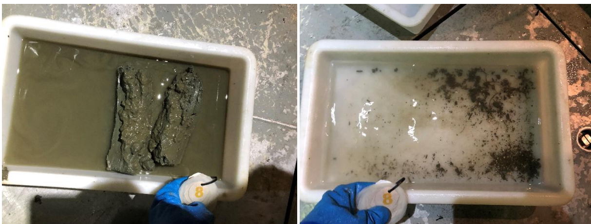
Figur 13: Bilder som viser sedimentet fra stasjon 8 før og etter siling. Sedimentet besto av leire og silt. Foto: Aqua Kompetanse AS.
