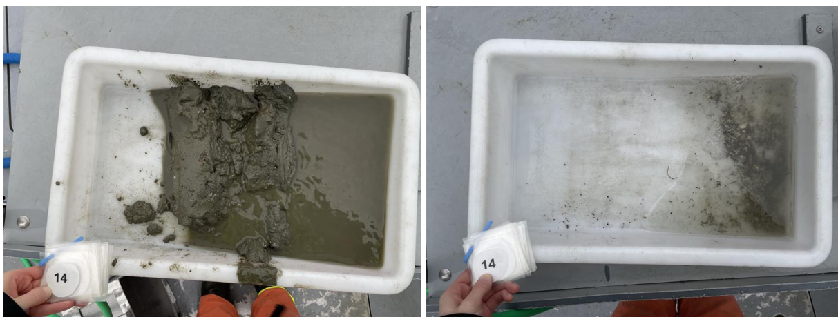
Figur 19: Bilder som viser sedimentet fra stasjon 14 før og etter siling. Sedimentet besto av leire, silt og sand. Foto: Aqua Kompetanse AS.
