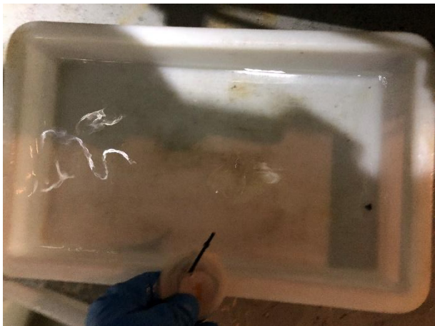
Figur 6: Bilde som viser prøven fra stasjon 1. Sedimentet er fraværende grunnet hardbunn. Foto: Aqua Kompetanse AS.
