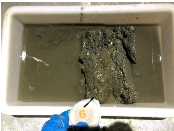
Figur 11: Bilder som viser sedimentet fra stasjon 6 før og etter siling. Sedimentet besto av leire og silt. Foto: Aqua Kompetanse AS.
