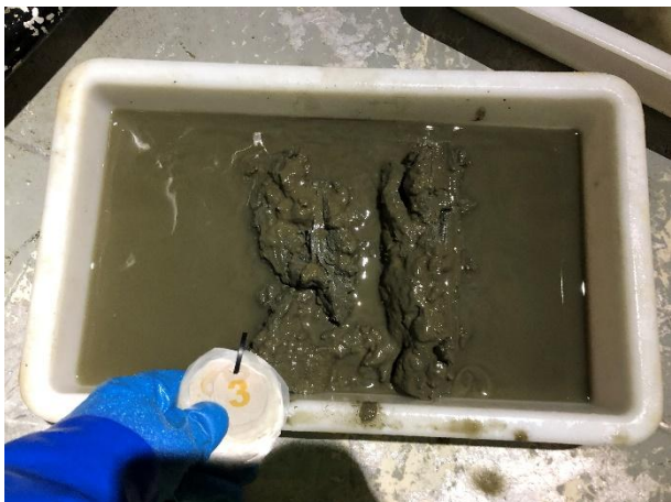
Figur 8: Bilder som viser sedimentet fra stasjon 3 før og etter siling. Sedimentet besto av leire og silt. Foto: Aqua Kompetanse AS.
