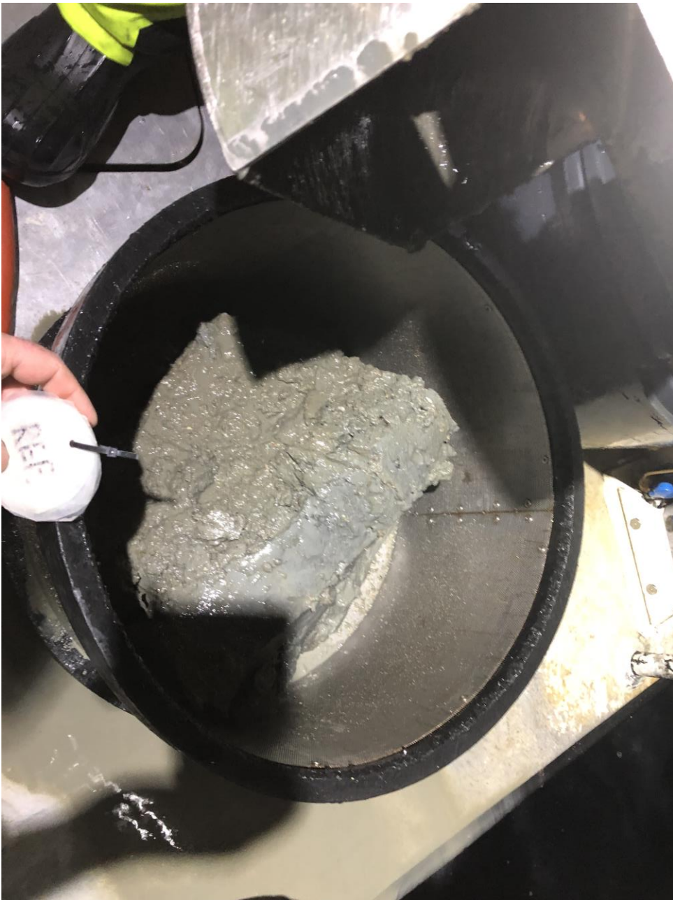
Figur 6-4: Bilde av sedimentet ved C-ref. Sedimentet besto av leire og skjellsand. Foto: Aqua Kompetanse AS.
