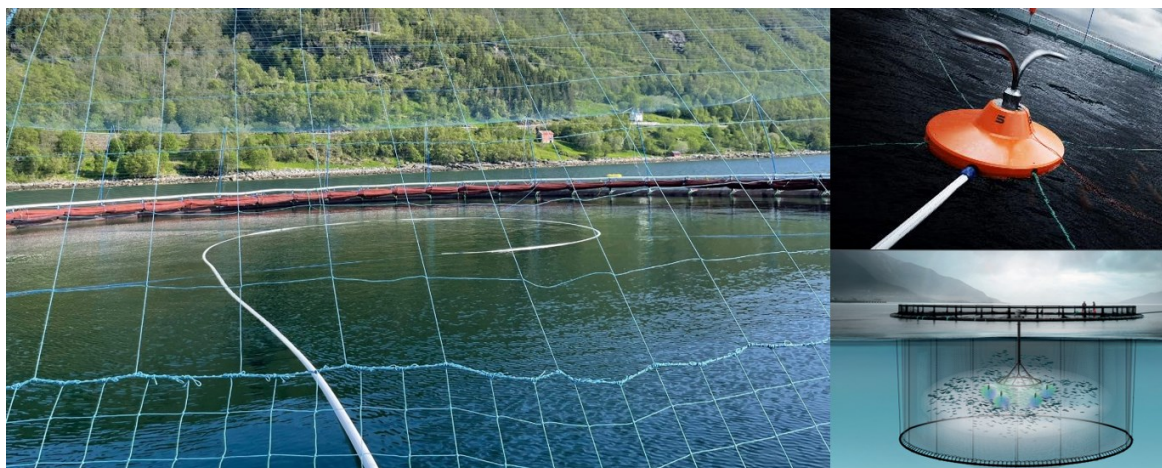
Figur 3 Perforert fôrslange rigget i merd. Bildet er fra lokalitet Forså i Ibestad kommune (KIME Akva AS). Til høyre er andre teknologiløsninger som utprøves vinteren i 2023.
