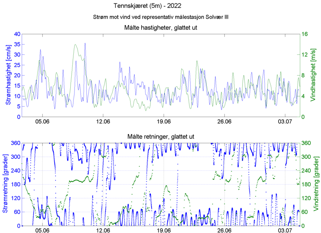
Figur 6. Øverst: Hastigheter for reststrøm (strømmen som ikke er påvirket av tidevannet) ved lokaliteten og vind ved Solvær III i måleperioden. Nederst: Retning for strøm og vind. Kurvene er glattet ut for å øke lesbarheten. Vind og strømretninger er satt opp slik at de leses i samme retning. Vind og strøm går mot gitt retning.
