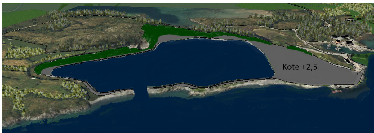
Figur 13. Avsluttet uttak. Det er sprengt ut en åpning til sjøen slik at utsprengt areal fylles med sjøvann.
