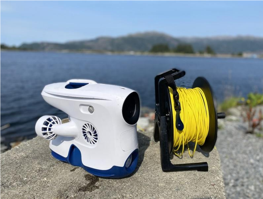
Figur 3-1: ROV (Blueye Pioneer), Ipad og konsoll ble brukt til kartlegging av sjøbunn på gruntvann.
