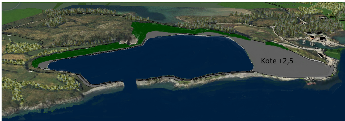
Figur 32. Avsluttet uttak. Det er sprengt ut en åpning til sjøen slik at utsprengt areal fylles med sjøvann.
